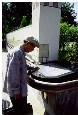
Figura 25 – Mapa tátil, com informações escritas e em braile, mapa em relevo e botão para sistema de som. Fonte: Young e Trachtman (2000).
